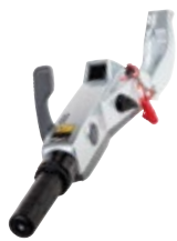
BARRA DI COMANDO MULTIFUNZIONE (BF40D & BF50D)
